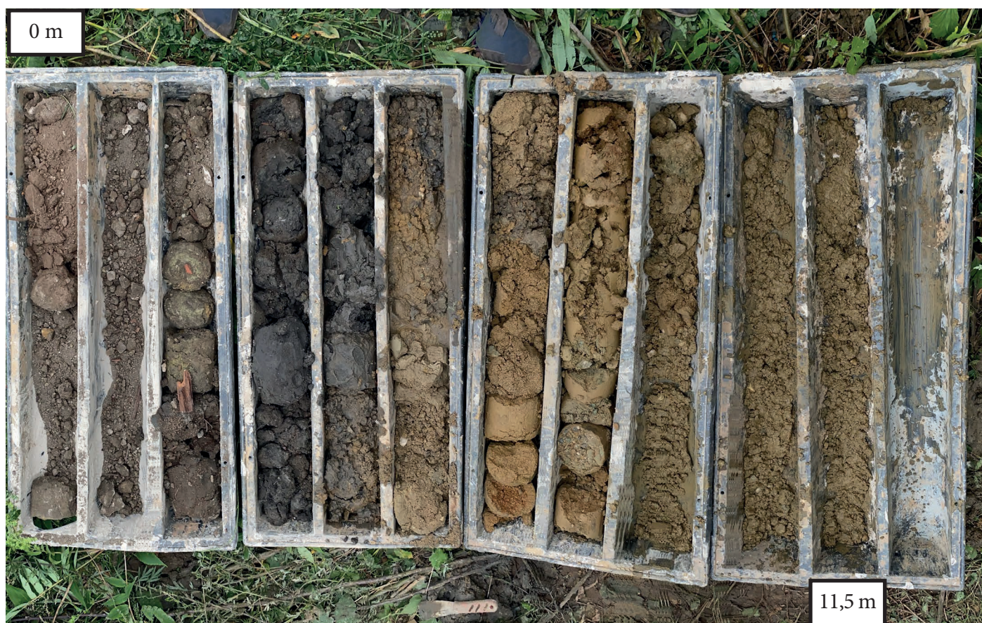
Geologický profil vrtu J1
